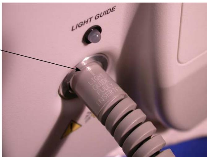
**Conseil :** Quand le guide optique est complètement inséré, le repère sur l'étiquette d'insertion du guide optique est de niveau avec la surface de la prise du guide optique. En outre, la DEL au-dessus de la prise s'allumera et deviendra verte quand l'appareil sera mis sous tension. Si le guide optique n'est pas complètement inséré dans la prise, la DEL deviendra rouge.
