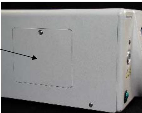
**Conseil :** des attaches pratiques pour retenir la clé hexagonale sur le X-Cite exacte sont présentes sous le boîtier du système.
